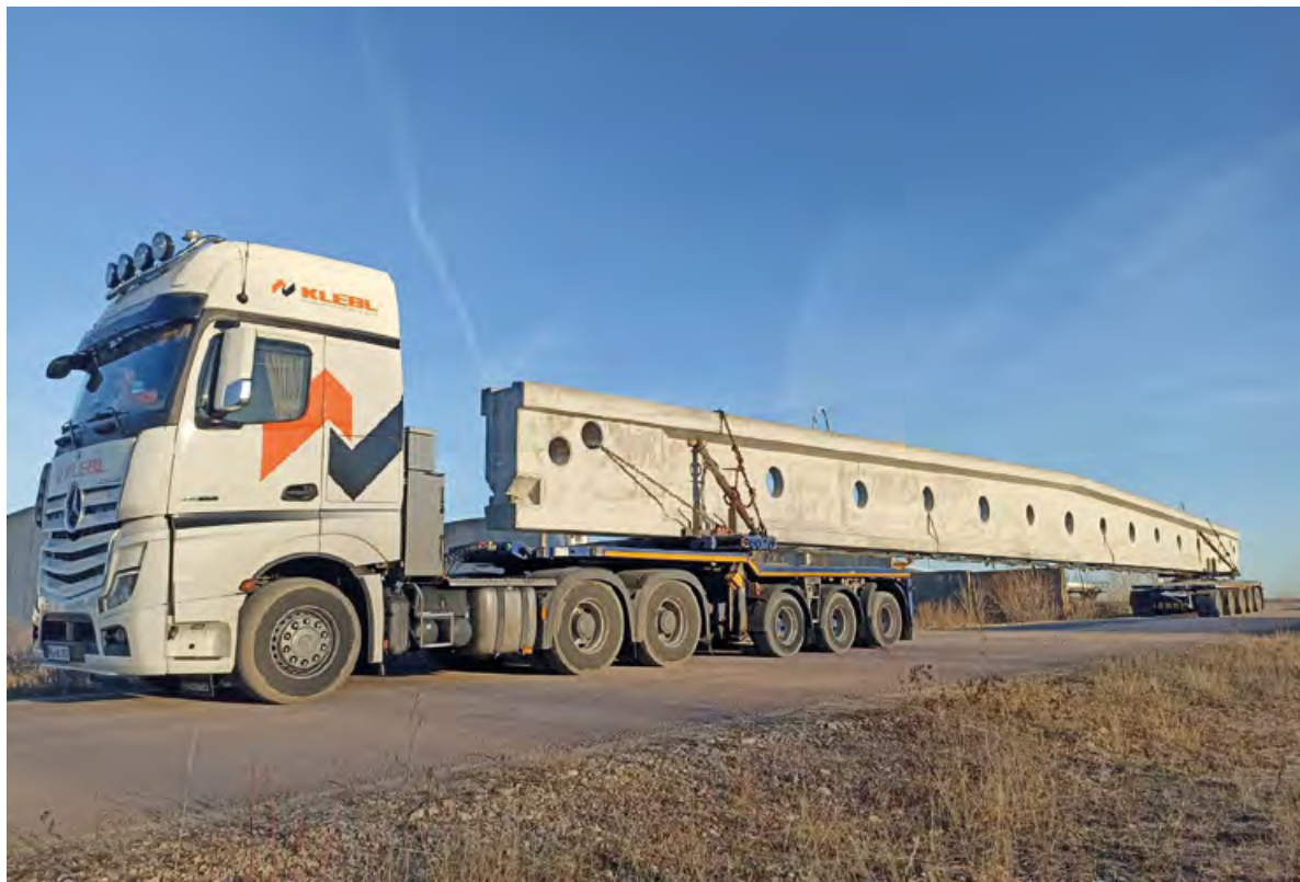
Transport eines Abfangträgers.
